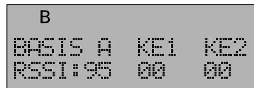
In der oberen Zeile werden Ihnen maximal die drei stärksten (soweit vorhanden) Basisstationen angezeigt. In der unteren Zeile wird deren Feldstärke verglichen. Ist die Feldstärke zu schwach, wird dies durch zwei Striche (- -) angezeigt. Mit der **Menütaste** verlassen Sie diese Funktion.
