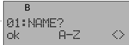
Die Eingabe erfolgt über die **Zifferntasten**. Jeder Ziffer sind mehrere Zeichen zugeordnet, die Sie oberhalb der Tasten auf dem Gehäuse finden.
